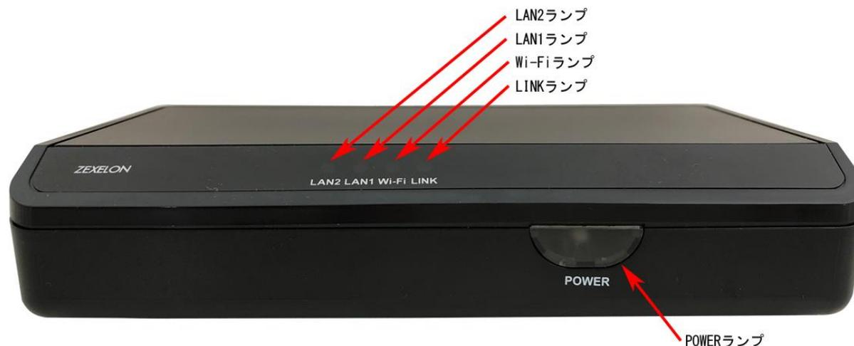
「POWER」ランプ … 電源「ON」時に点灯します。
