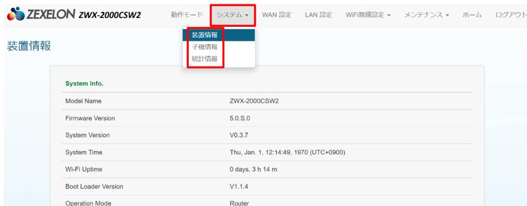
The screenshot shows the ZEXELON ZWX-2000CSW2 web interface. The top navigation bar includes '動作モード', 'システム', 'WAN 設定', 'LAN 設定', 'WIFI無線設定', 'メンテナンス', 'ホーム', and 'ログアウト'. The 'システム' menu is highlighted, and a dropdown menu shows '装置情報', '子機情報', and '統計情報'. The '装置情報' sub-menu is selected, leading to the 'System Info.' page. The page displays the following system information:
